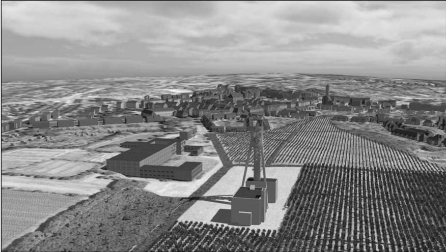
Abb. 6: Digitales Geländemodell mit überlagertem Orthophoto und texturierten 3D-Gebäudeobjekten (LOD2)
