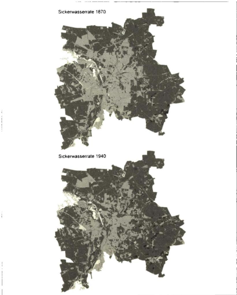
Abb. 6a: Veränderung der Sickerwasserrate im Untersuchungsgebiet Leipzig seit 1870 basierend auf der Berechnung mit ABIMO
