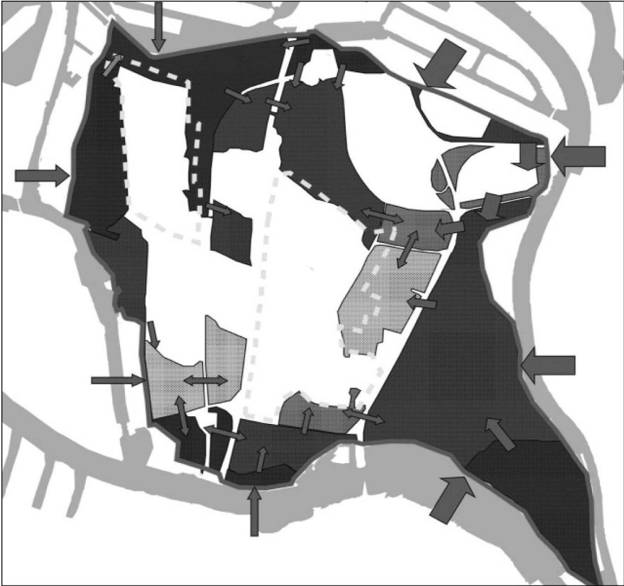
Abb. 3: Kompartimentierung der Elbinsel Hamburg-Wilhelmsburg zur Realisierung einer zweiten Deichlinie (PASCHÉ et al. 2008)
